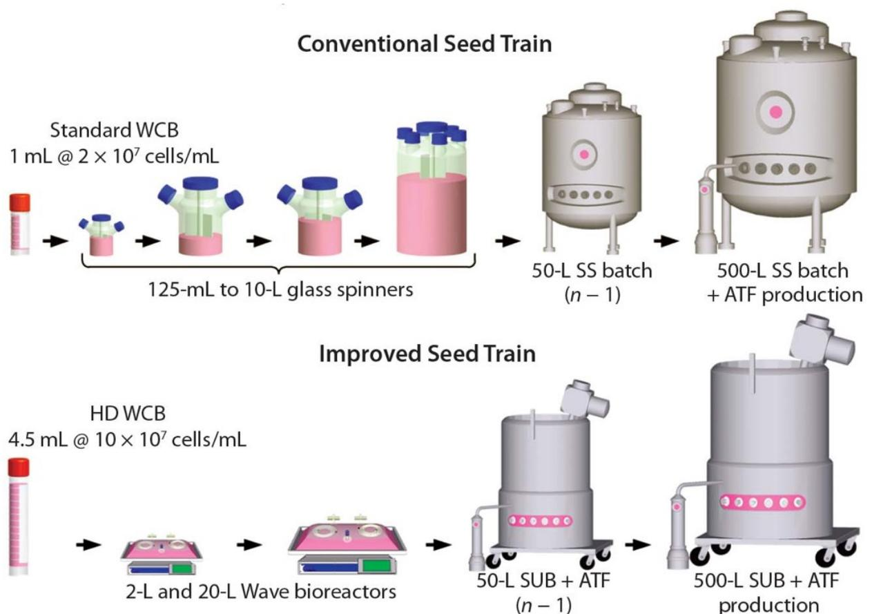
Die Abbildung vergleicht einen neuartigen Seed-Train-Prozess mit HD-Zellbanking, Einweg-Wave-Bioreaktoren und Refine Technology's Alternating Tangential Flow (ATF) Perfusions-Zellkulturtechnologien mit einem konventionellen Prozess. Ein Beispiel für diesen Prozess für
